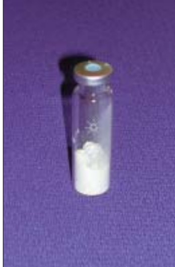
När provet från betongkonstruktionen tagits fylls betongpulvret i en glasvial och tas till ett laboratorium för analys.
