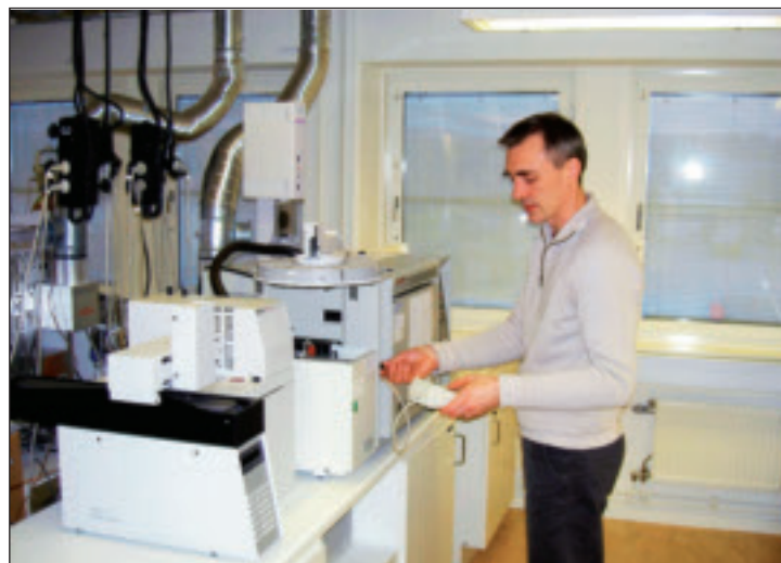
Den kemiska analys som Karl-Olof Schoeps gör i Pegasus lab visar bland annat i vilken omfattning 1-butanol och 2-etylhexanol finns fördelade på olika djup i betongprofilen
