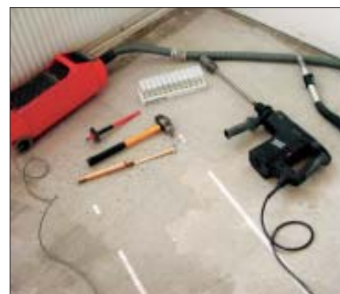
På bilden ovan den provtagningsutrustning som behövs för kemisk betongprofilanalys
