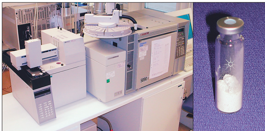
Figur 1. Analysinstrument. Headspace kopplat till GC/MS (vänster), samt glasvial med betongprov för analys (höger).
